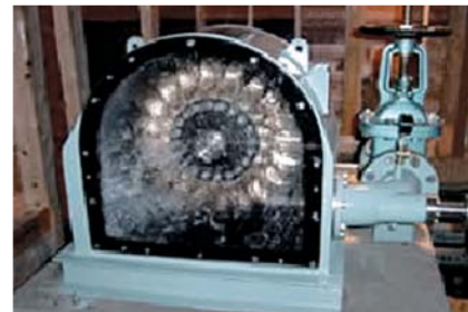
ペルトン水車発電機
